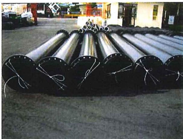
弊社が発注したプラスチック製の排送管。鉄製に比べてコストがかなり抑えられます。
