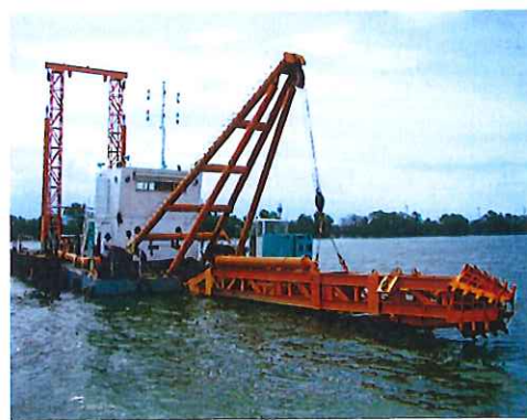
浚渫船 350 t 450\text{m}^3/\text{h}
