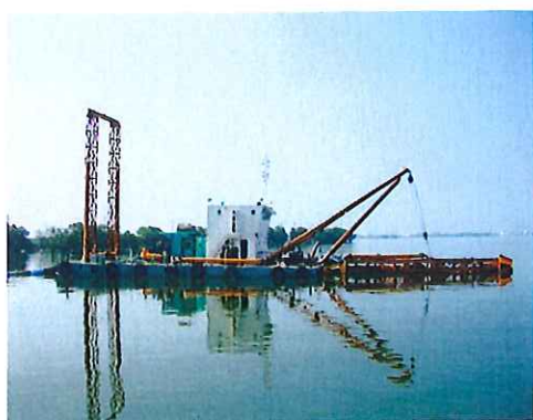
浚渫船 350 t 450\text{m}^3/\text{h}
