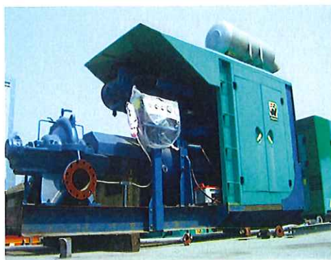
高圧駆動ポンプ 20\text{kgf}/\text{cm}^2
